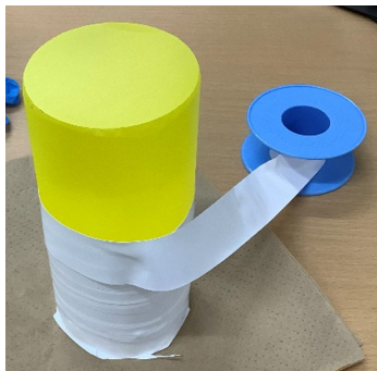
図 28: (左) 金研で作製した大型 GFAG 結晶に反射材のテフロンテープを巻いているところ。(右) 神岡地下実験室の鉛シールドで 7 月に行った実験の様子。
