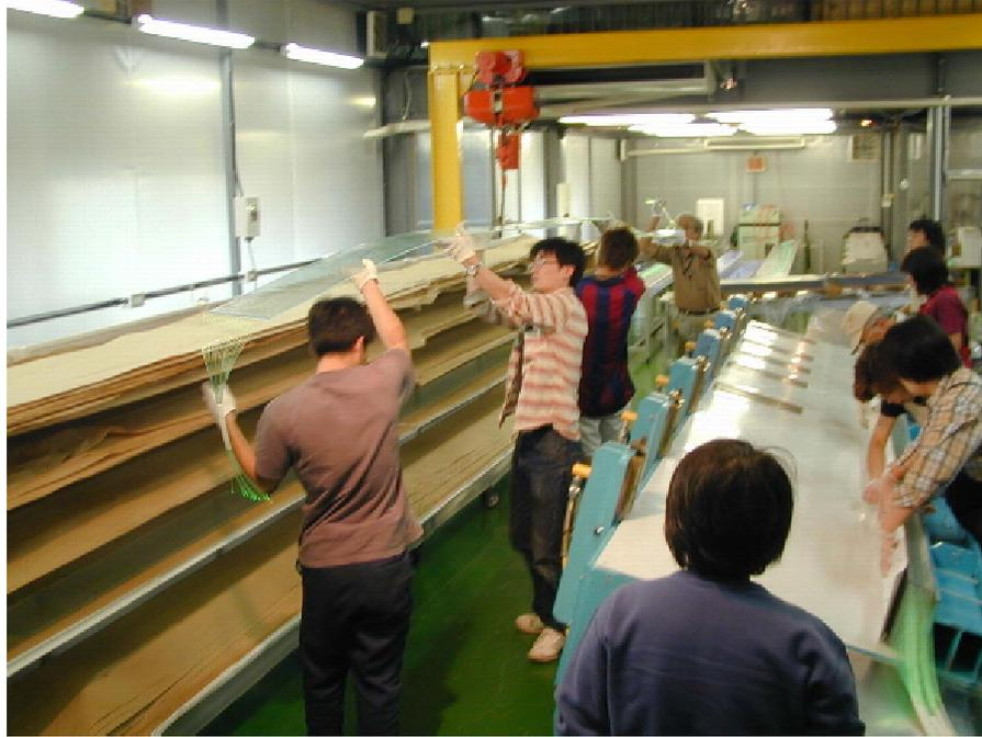
図 42: 崩壊領域を囲む Main Barrel という鉛とシンチレータを積層した測定器を組み立てている様子。
