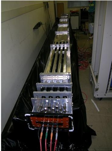
図 74:  $\pi^+$  や  $\mu^+$  の静止距離を高精度で測るレンジカウンターのプロトタイプ（全長 4.56m）。1820mm 長のプラスチック・シンチレータ 4 枚/層を 4 層積層した両端に、シンチレータ端面の半分の断面積を持つアクリル・ライトガイド（940mm 長）をそれぞれ取付けて 1 セクターとした。
