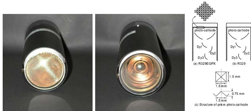
図 57: 左が今回開発したプリズム型光電面光電子増倍管 (R329-EGP), 中央が通常の光電子増倍管 (R329) の写真。プリズム形状の構造を右に示す。
