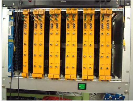
図 66: KEK 回路室との共同研究で開発された 500MHz トランジェントディジタイザの 6 U-VME モジュール。
