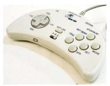
シグマ光機4軸コントローラの電源を入れる コントロールパッドのModeを数回おしてManual Modeに
