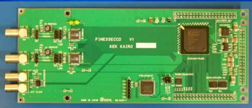
CCD用12bit 20MHz ADC
