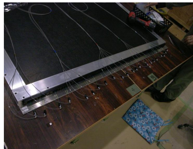
ファイバーの挿入 & ケーブリング
